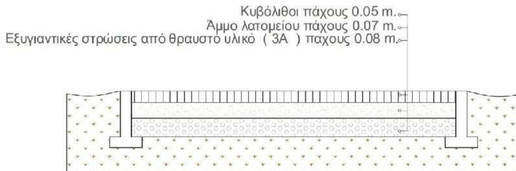
Τομή ενδεικτικής εφαρμογής κυβόλιθου
