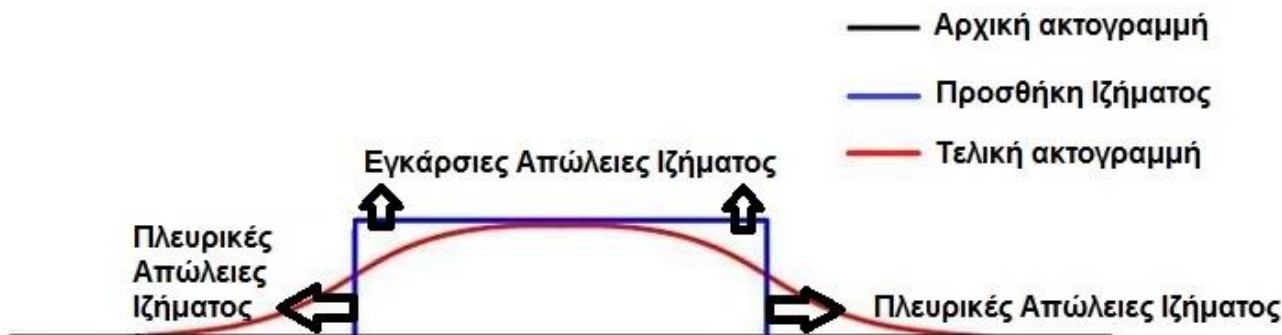
Εικόνα 8.2 : Απώλειες άμμου στην περίπτωση τεχνητής ανάπλασης ακτής
