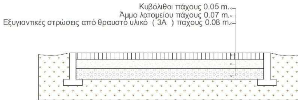
Τομή ενδεικτικής εφαρμογής κυβόλιθου
