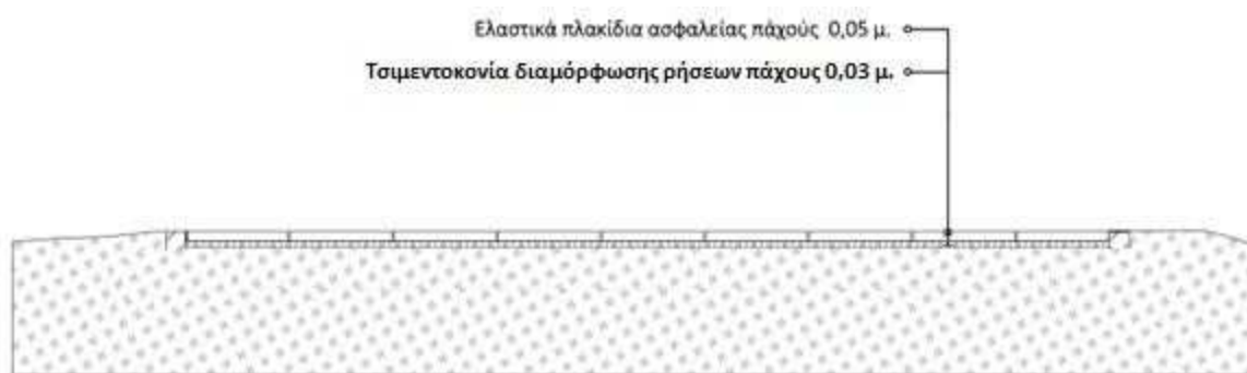
Εικόνα: Διατομή ενδεικτικής εφαρμογής δαπέδου ασφαλείας
