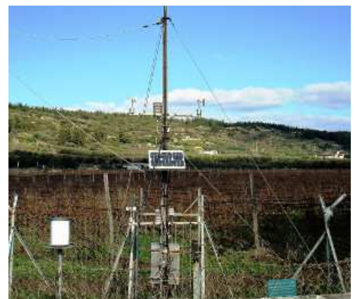
Αυτόματος μετεωρολογικός σταθμός
